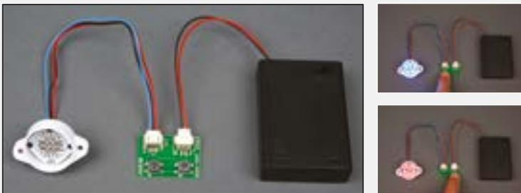
Включите батарейный отсек, затем поочередно нажмите на кнопки S1 и S2, чтобы убедиться, что светодиодный индикатор состояния процессора функционирует правильно. Батарейный отсек снабжён переключателем с надписью ON / OFF. Включите его, прежде чем тестировать индикатор, а затем снова выключите, чтобы не расходовать батарейки.
