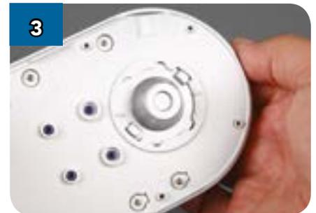
Установите деталь (LPR-32) в указанное отверстие, совместив выступы с вырезами. Здесь используется соединение байонетного типа, которое позволяет снимать осевую крышку в любое время.
